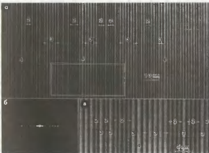
Рис. 1.10. Изображение: а) кристаллической решетки и б) картины электронной дифракции высокотемпературного сверхпроводника на основе соединения висмута; в) увеличенное изображение участка внутри рамки, показанной на рис. 1.10а
