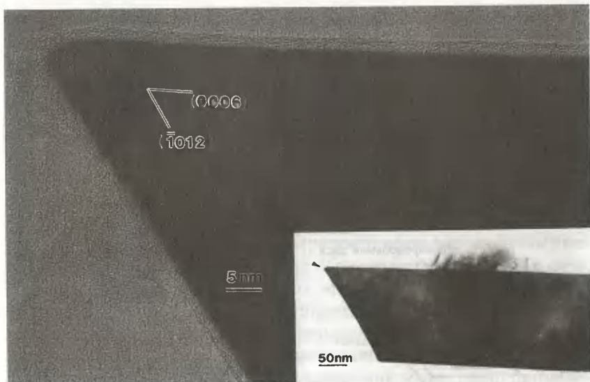
Рис. 5.43. Электронные микрофотографии высокого разрешения поперечного среза пластинчатовидной частицы гематита. Область изображения соответствует участку, показанному на рисунке внизу справа, полученном при более низком увеличении
