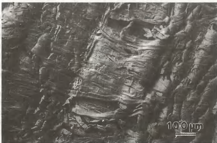
Рис. 5.36. Растровое электронное изображение поверхности бумаги, полученное с помощью низковакуумного РЭМ. Ускоряющее напряжение 15 кВ (низковакуумный РЭМ модели JSM-5300LV)
