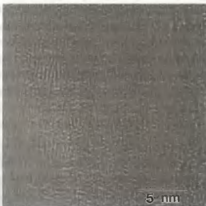
Рис. 2.39. Контраст изображения аморфной пленки, демонстрирующий астигматизм объективной линзы
