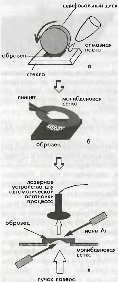
Рис. 5.44. Процедура пробоподготовки для метода ионного травления
