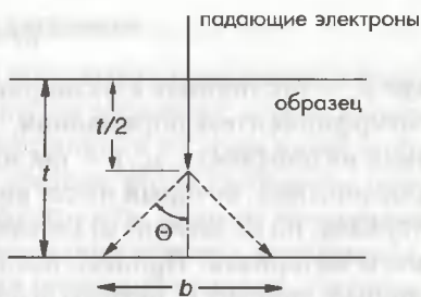
Рис. 1.2. Уширение электронного пучка в образце
