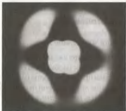
Рис. 2.34. Картина эмиссии катода \text{LaB}_6 в условиях недонасыщения
