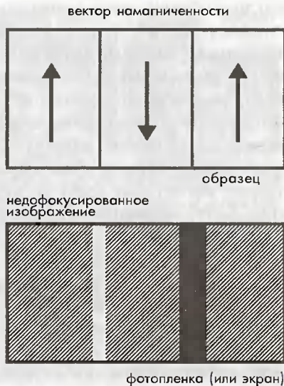
Рис. 5.31. Связь между распределением намагниченности в образце и контрастом изображения, наблюдаемым в условиях недофокусировки в режиме Френеля. Предполагается, что электронный пучок падает на плоскость рисунка сверху вниз
