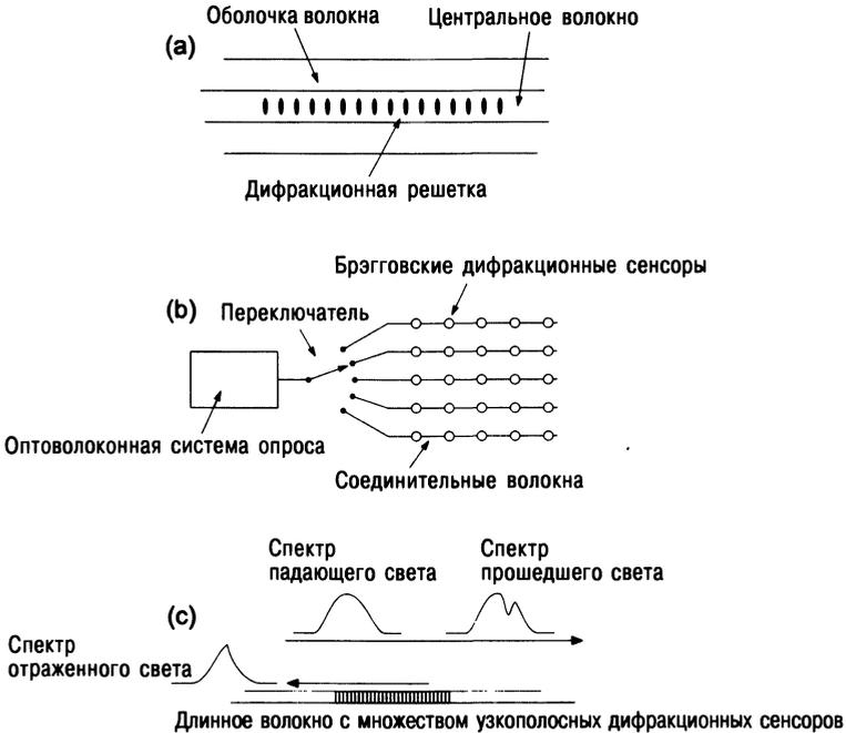
**Рис. 2.8.** Волоконная оптическая дифракционная решетка, измеряющая длину отраженной волны; (а) — геометрия решетки; (б) — режим работы; решетка отражает свет определенной длины волны; (с) — мультисенсорное волокно; каждая решетка работает в различном диапазоне длин волн.
