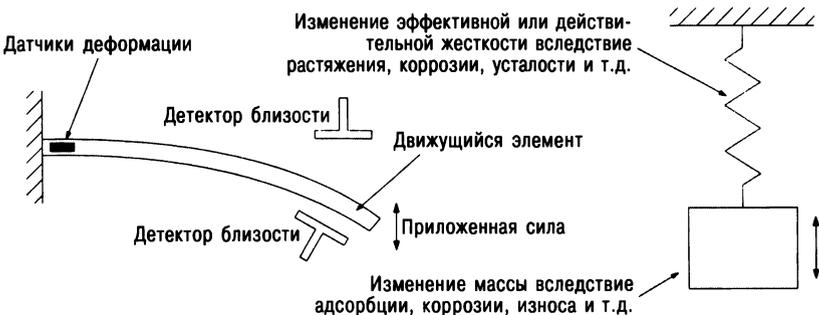
Рис. 2.14. Методы модуляции МЭМС-датчиков: модуляция по координате и модуляция резонансной частоты.
