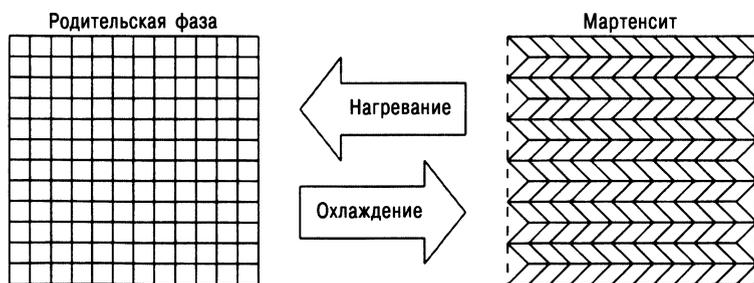
Рис. 5.1. Схематическое изображение термоупругого мартенситного перехода.
