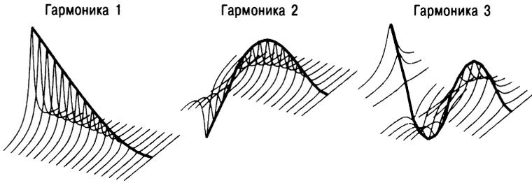
Рис. 3.5. Гармоники колебаний консольной балки.
