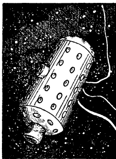
Рис. 4. Обсерватория в виде котла. Давление внутри ее 1 атм. Видны два шлюза, два электрических кабеля, гибкая труба и алюминиевые торцы.
