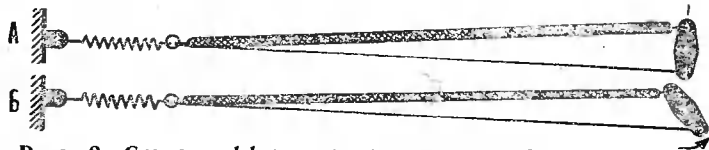
Рис. 2. Схема дифференцированного датчика, реагирующего на скорость возрастания температуры: А — при медленном возрастании температуры обе нити меняются одинаково; Б — при резком возрастании температуры в первую очередь удлиняется незащищенная нить.
