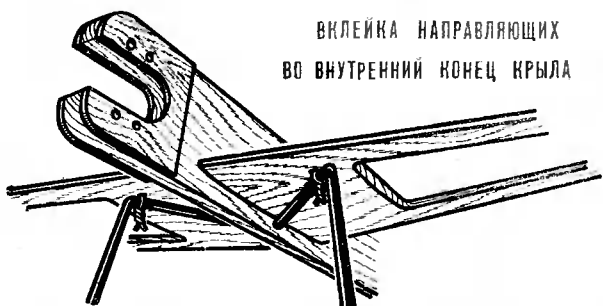
КРЕПЛЕНИЕ СТОЕК ШАССИ
