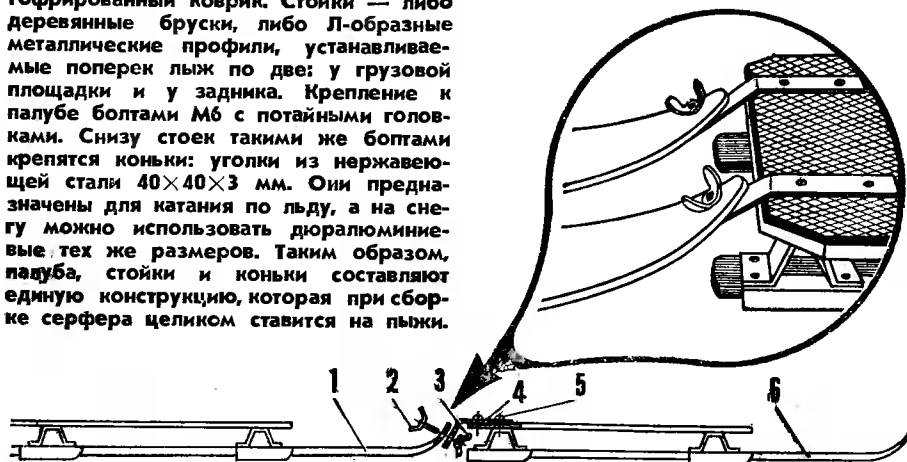
Рис. 4. Соединение секций тандема:
