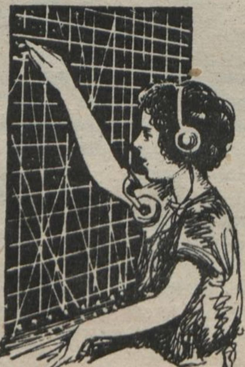
соединений. На этих досках — гнезда; каждое гнездо с проводом одного из телефонов. Около каждой доски сидят четыре телефонистки с наушниками.
