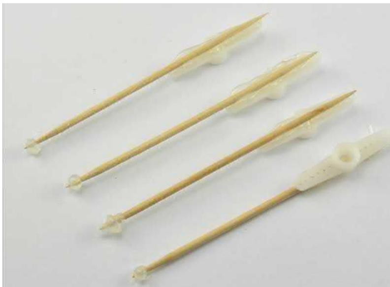
Рис. 9.11. Удлинение качалок серводвигателей
