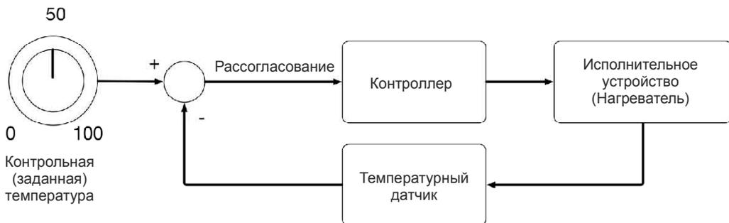
Рис. 12.1. Контур управления (на примере термостата)
