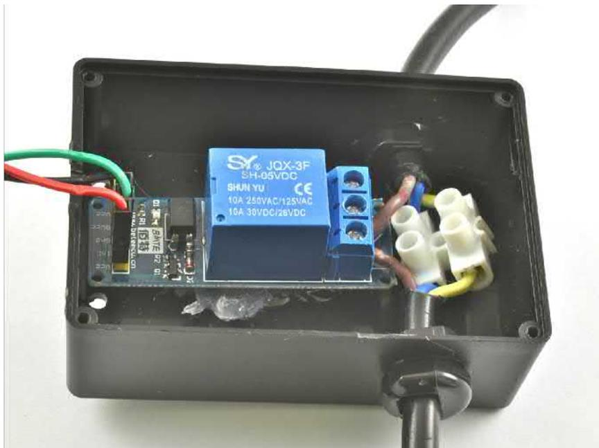
Рис. 13.6. Релейный модуль в пластмассовом корпусе
