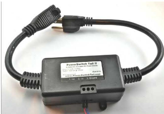
Рис. 13.8. Твердотельное реле PowerSwitch Tail
