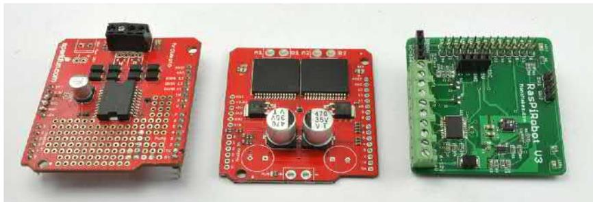
Рис. 8.16. Шилды с H-мостами для Arduino и Raspberry Pi
