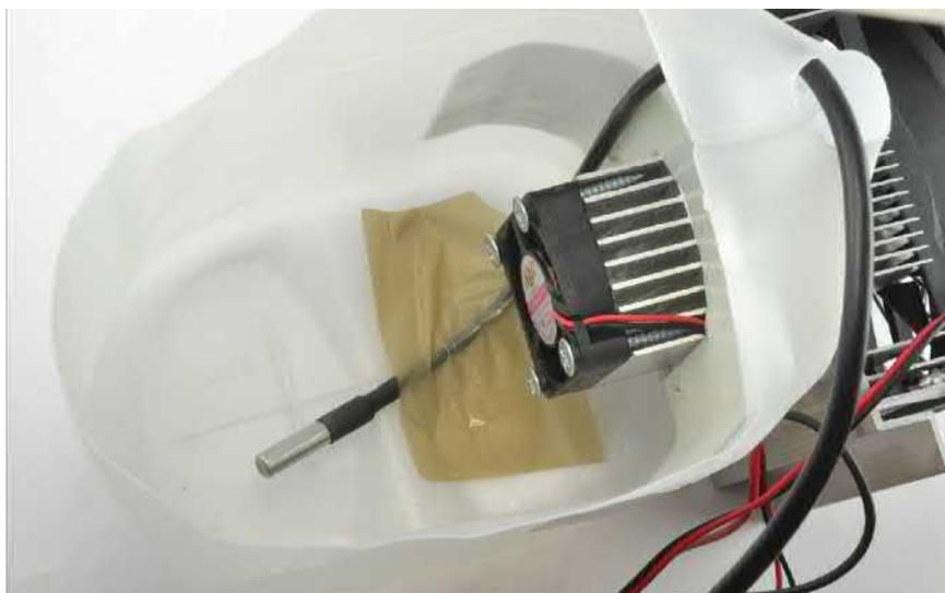
Рис. 12.19. Добавление температурного датчика
