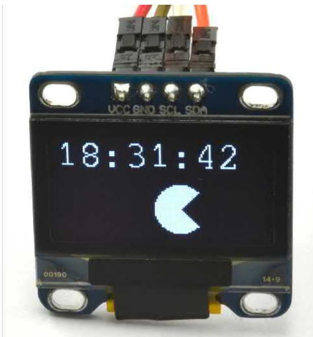
Рис. 14.7. Дисплей на основе технологии OLED
