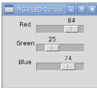
Рис. 6.13. Перемещаем ползунки для изменения цвета RGB-светодиода
