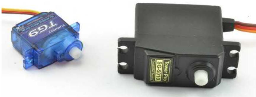
Рис. 9.1. Сервопривод 9g (слева) и стандартный серводвигатель (справа)
