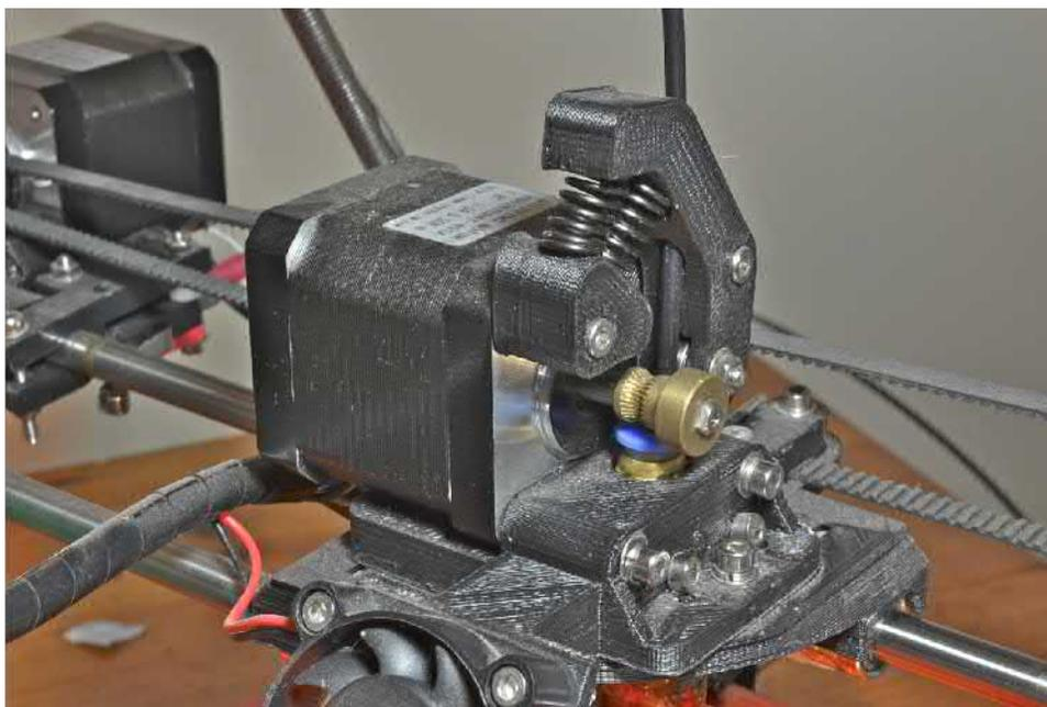
Рис. 10.1. Шаговый электродвигатель в 3D-принтере
