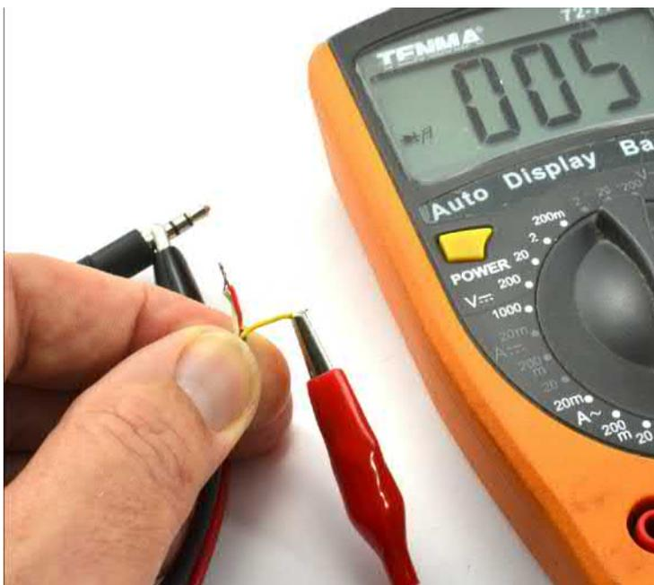
Рис. 15.7. Тестирование входного кабеля звукового сигнала
