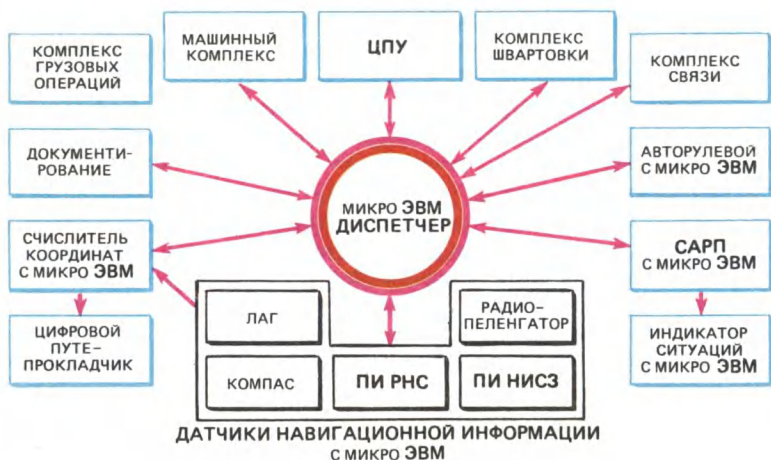
Рис. 76. Структурная схема системы автоматизации судовождения с децентрализованным управлением
