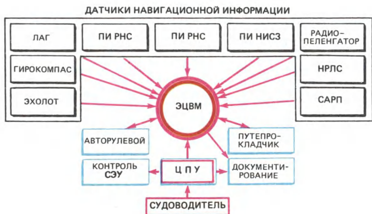
Рис. 75. Структурная схема системы автоматизации судовождения с централизованным управлением
