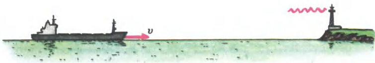
Рис. 44. Принцип измерения скорости судна доплеровским методом
