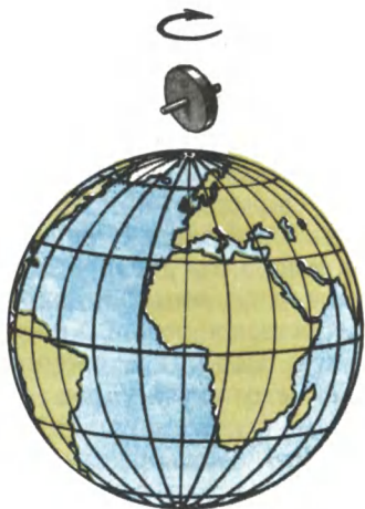
Рис. 27. Видимый уход гироскопа, установленного на полюсе
