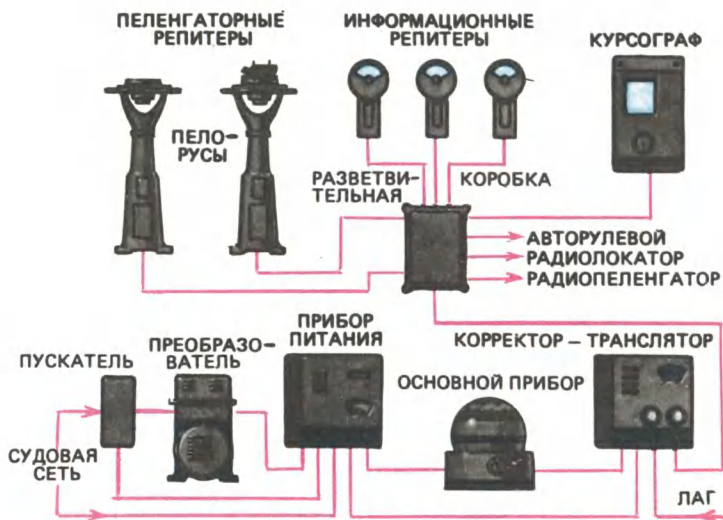
Рис. 29 Состав приборов гироскопического компаса „Бера”
