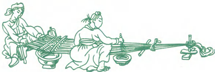
Ткачество из пеньковых нитей в Древней Корее. На переднем плане женщина щеткой наносит рисовый отвар на основу
