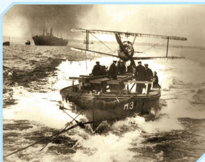
Перехватчик «Кэмел» 2F.1 с лыжным шасси на лихтере, буксируемом за эсминцем. Взлетев с такого катера над Северным морем, этот самолет сбил Цепелин L 53.
