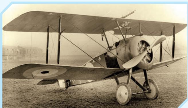
Стандартный морской истребитель Сопвич «Кэмел» 2F.1 с одним синхронным и одним надкрыльевым пулеметом — вариант для базирования на авианосцах и крейсерах. Фото: <http://www.avionslegendaires.net/wp-content/uploads/2009/01/Gcamel-index.jpg>
