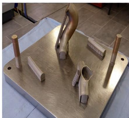
Рис. 13. Образцы продукции, полученные на установке SLM 280 в «КБ «Южное»
