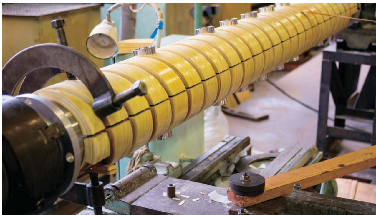
Винтовая секция СМОЛЫ, новой экспериментальной открытой магнитной ловушки для плазмы
