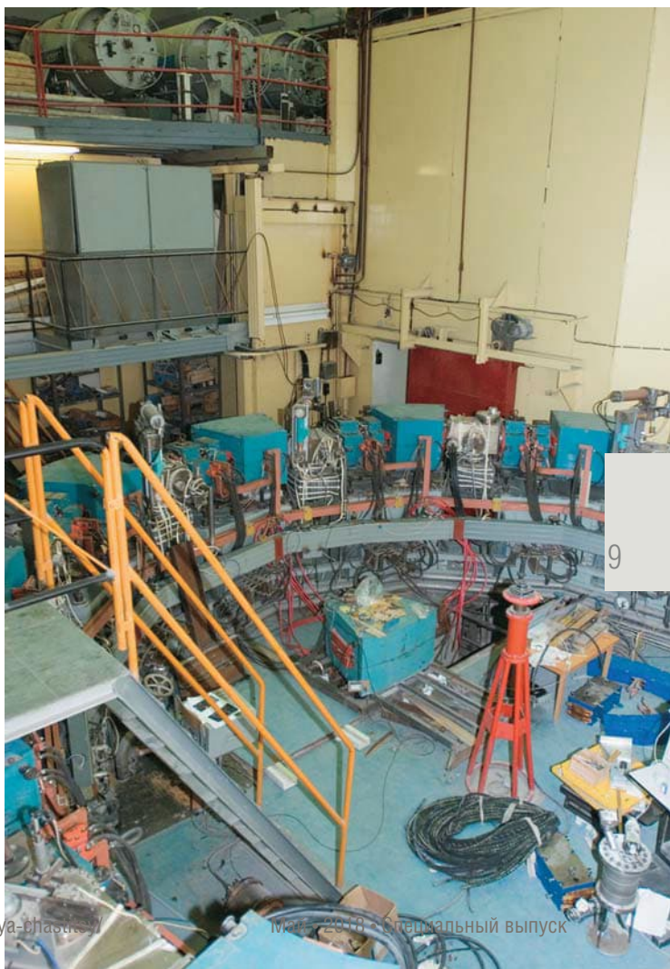
Комплекс ВЭПП-2М. Работал в диапазоне энергий 0,4 — 1,4 ГэВ. Максимальная достигнутая светимость — 5 \times 10^{30} \text{ см}^{-2} \times \text{сек}^{-1} на энергии 510 МэВ
