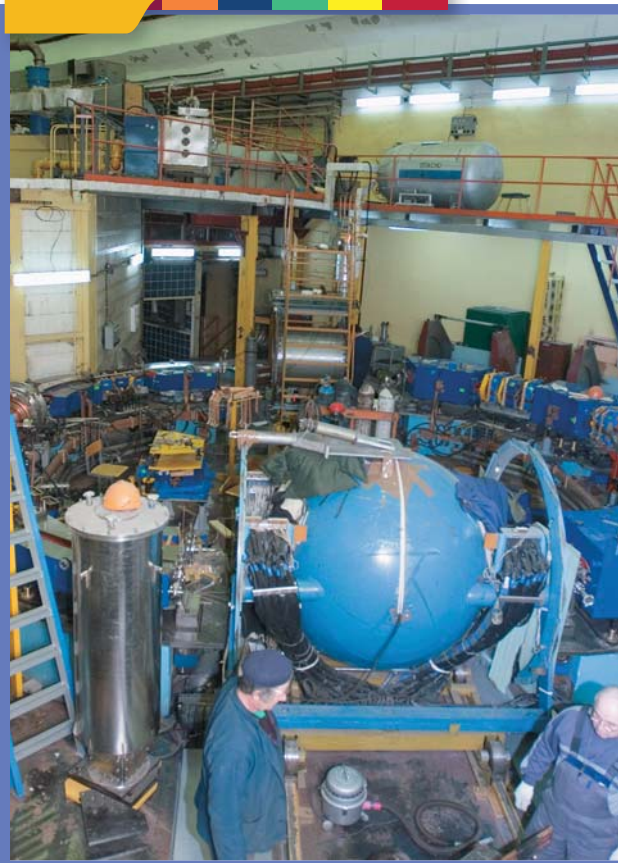
Бустерный синхротрон Б-4, где происходит предварительное ускорение электронных (позитронных) пучков до энергии инжекции (360 МэВ) в накопитель ВЭПП-3
