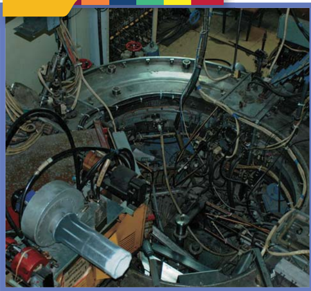
Бустерный синхротрон Б-4, где происходит предварительное ускорение электронных (позитронных) пучков до энергии инжекции (360 МэВ) в накопитель ВЭПП-3
