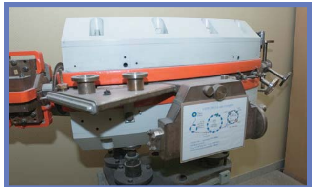
Комплекс ВЭПП-2М работал в диапазоне энергий 0,4 — 1,4 ГэВ. Максимальная достигнутая светимость — 5 \times 10^{30} см -2 ×сек -1 на энергии 510 МэВ. В 1972 г. заработал новый ускоритель ВЭПП-2М. Внизу – поворотный магнит ускорителя ВЭПП-2, ставший музейным экспонатом
