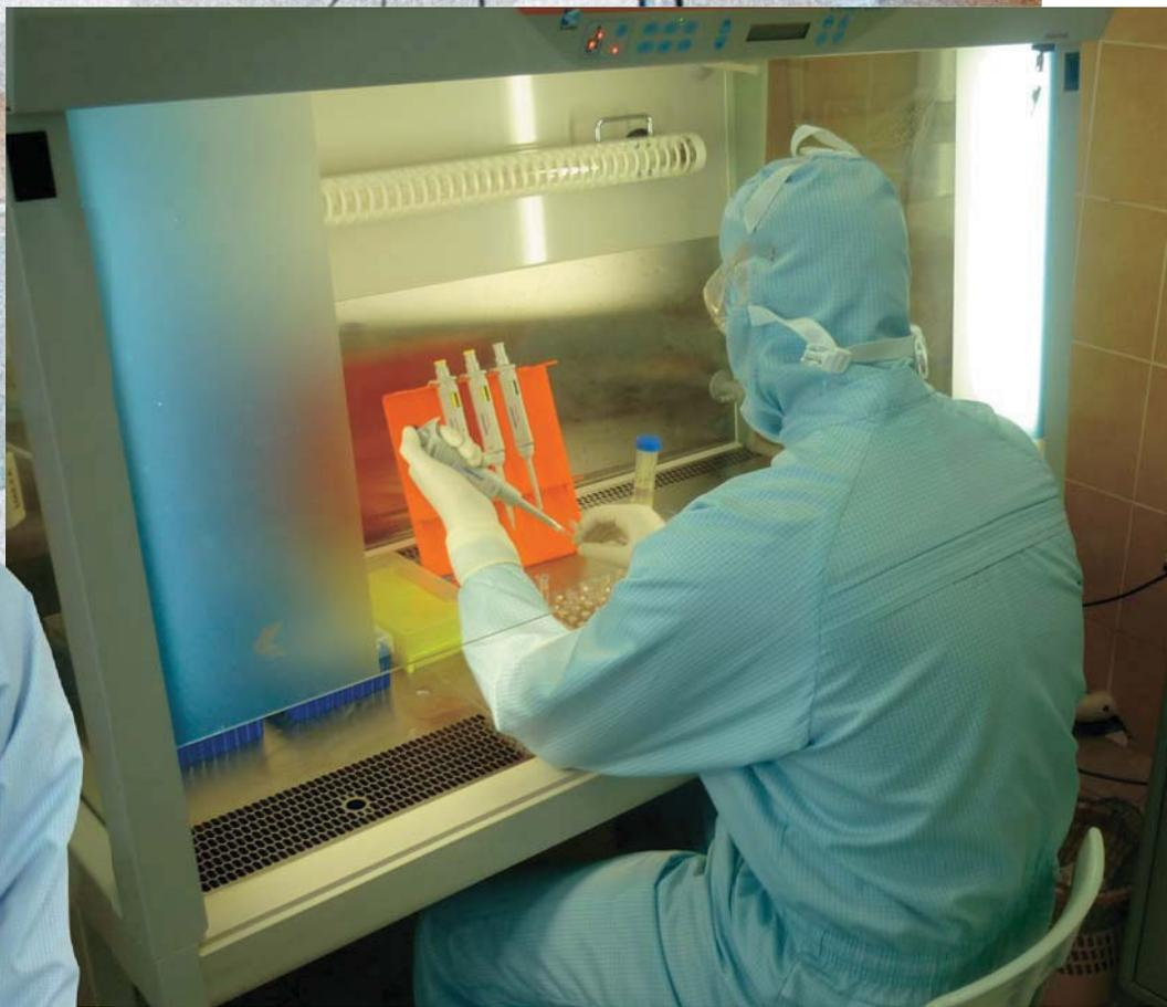
К палеогенетической лаборатории предъявляются гораздо более строгие требования, чем к обычной: высокая степень очистки воздуха, стерильное оборудование, которое не может быть использовано для других работ, специальная экипировка сотрудников, сверхчистые боксы, а также соблюдение специальных мер, предотвращающих загрязнение материала при сборе, хранении, доставке и подготовке к анализу.
