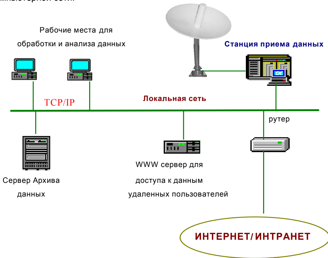
Рис. 3. Общая структура системы приема и обработки спутниковых данных в центре ГМО разработок (Санкт-Петербург).
