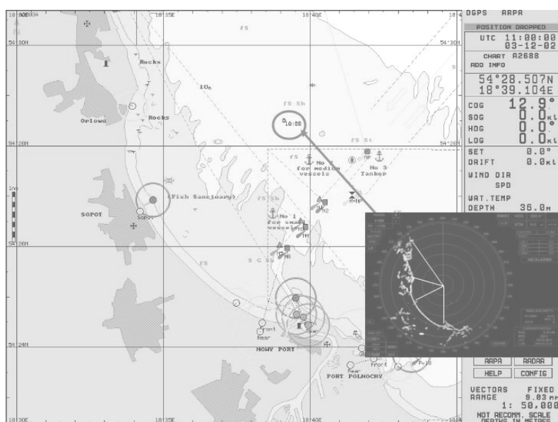
Рис. 4. Рассчитанная позиция судна P1 и ее радиолокационное изображение
