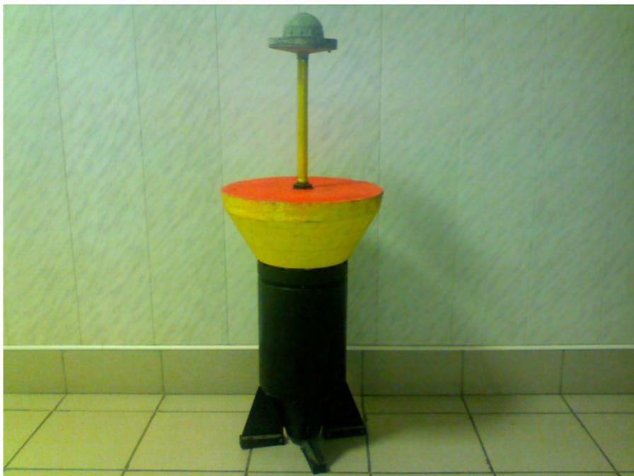
**Рис. 8. Дрейфующий автономный гидрометеорологический буй**
