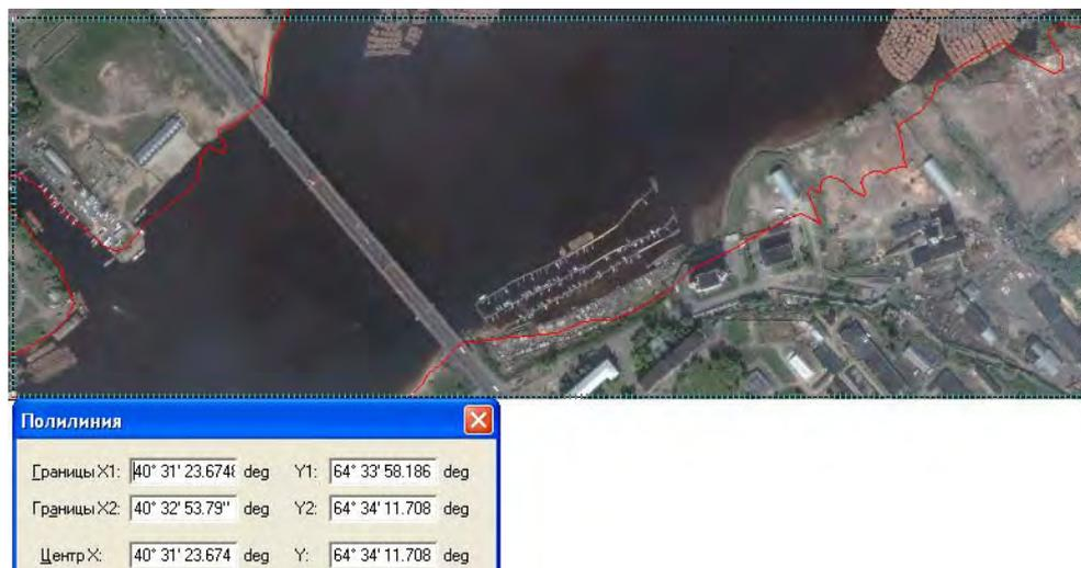
**Рис. 5. Порт Архангельск. Анализ векторных изображений береговой линии, опорных точек, СНО по файлам космической съемки с фиксированием для каждого фрагмента, имеющего принципиальное расхождение**
