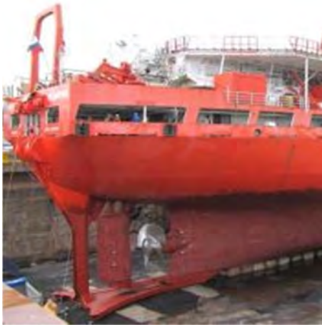
Рис. 2. Установка защитной конструкции Skeg в кормовой части НЭС «Академик Федоров»
