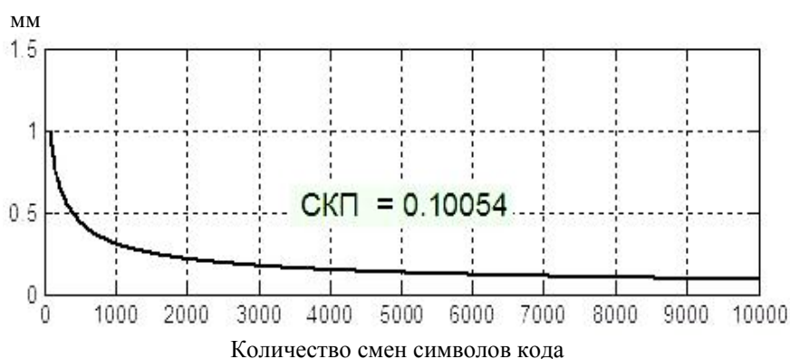
Рис. 4. СКП измерения псевдодальности (разложение в ряд Тейлора)
