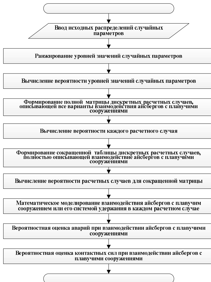
Рис. 4. Алгоритм вероятностного моделирования взаимодействия айсбергов с плавучими заякоренными сооружениями
