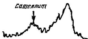
Рис. 2. а — спектрограммы рассеянного и возбуждающего света, полученные Г. С. Ландсбергом и Л. И. Мандельштамом 23—24 февраля 1928 г. (на спектрограмме рассеянного света (№ 8) с экспозицией 15 ч виден стоксов сателлит слева от линии рэлеевского рассеяния, обозначенной сверху 254, над ним спектр света ртутной дуги, отраженного от бархата; отпечаток с оригинальной спектрограммы сделан Л. В. Суховым; б — микрофотограмма спектральной линии возбуждающего света \lambda=253,6 нм; в — микрофотограмма спектра рассеянного света, выполненная А. А. Сычевым
