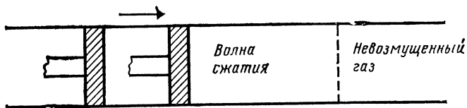
Рис. 2. Волна сжатия, образующаяся при движении поршня в трубе с газом
