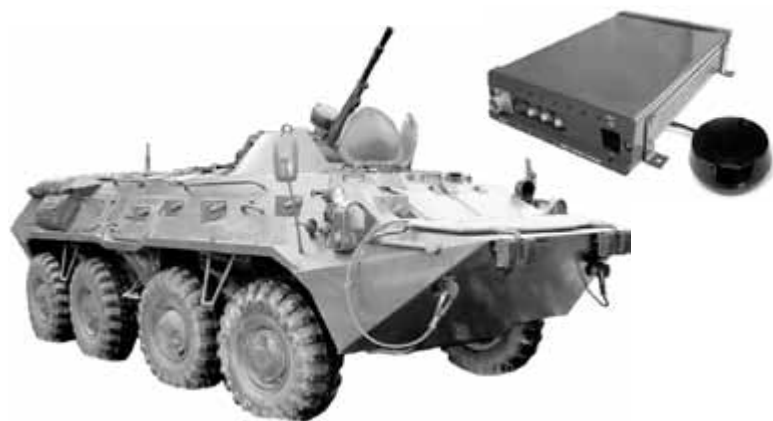
Рис. 4. Абонентский навигационный комплект (НАП-БТ)
