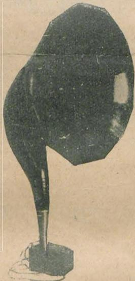
ного магнита, лакопечника из мягкого железа, на котором одеты маленькие катушечки (обмотки из изоляционной проволоки), насквозь железного якоря, расположенного между этими катушками и в конической мембране из тонкого металла. Репродуктор Божко на всеобщую радио-выставку награжден аттестатом-премией.
