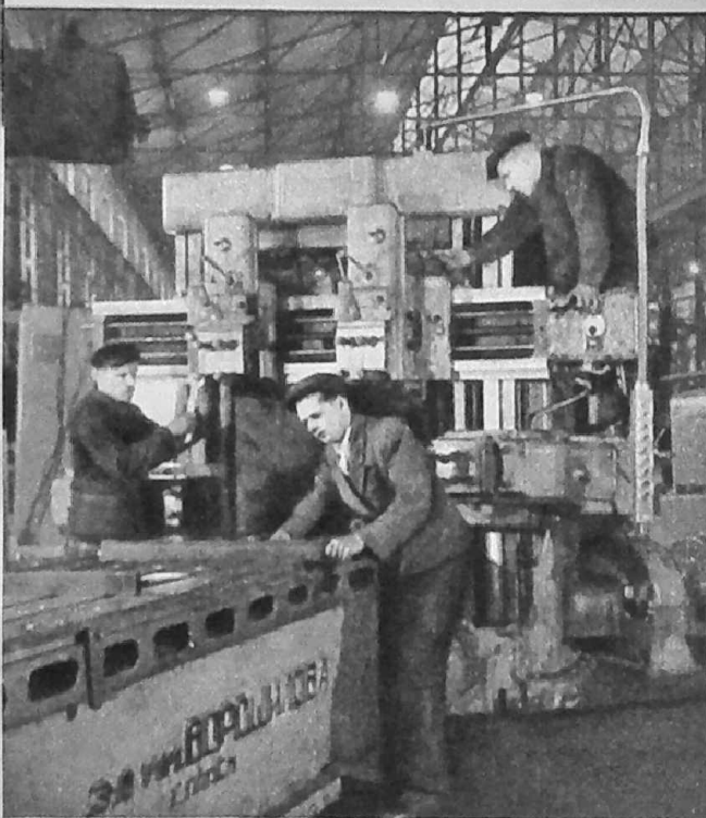
Станкозавод имени К. Е. Ворошилова. Слева направо: слесари-сборщики К. В. Некало, Н. И. Лимарев и И. А. Семичин за сборкой продольно-строгального станка.
