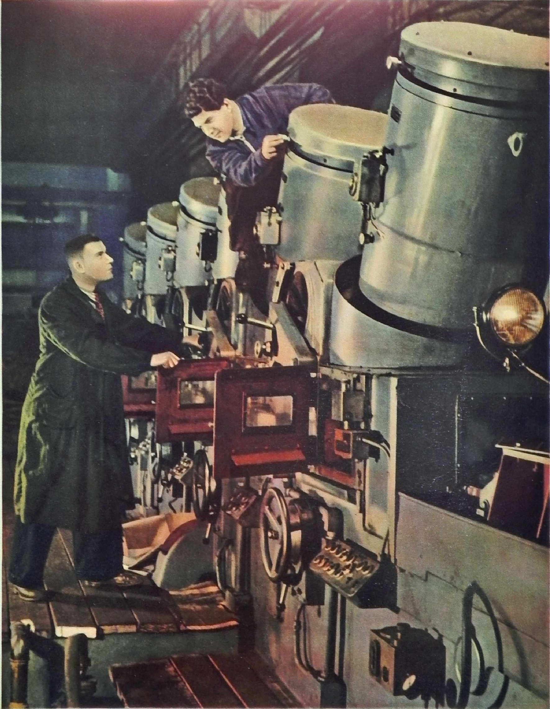
На Московском заводе шлифовальных станков производится наладка агрегата для комплексной шлифовки лемехов к тракторным плугам. На с и м к е: ведущий конструктор станка В. К. Радивилин (слева) и слесарь-наладчик П. П. Волков у станка.
