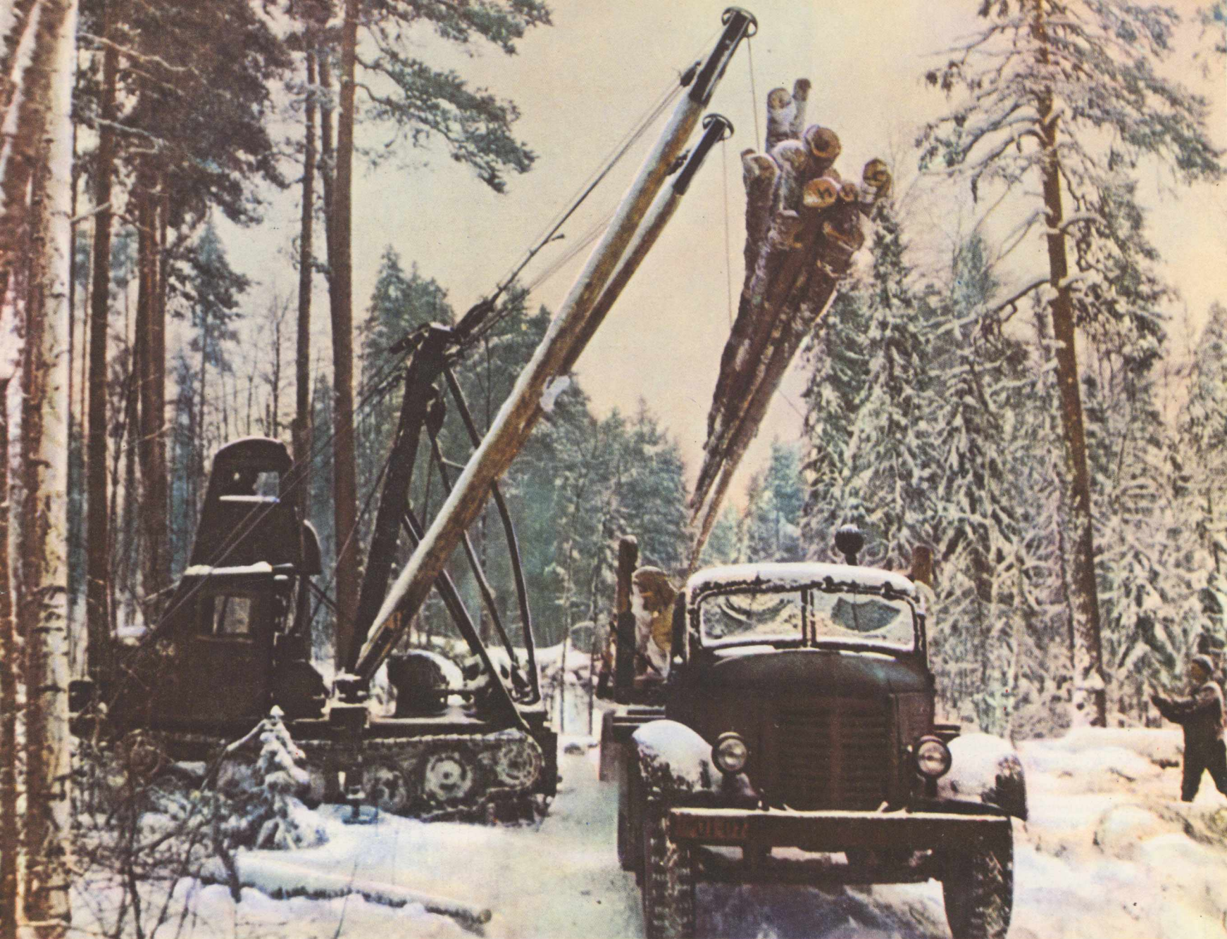
Этот трактор-кран грузит хлысты на автомашины и платформы и сам легко передвигается по лесу.
