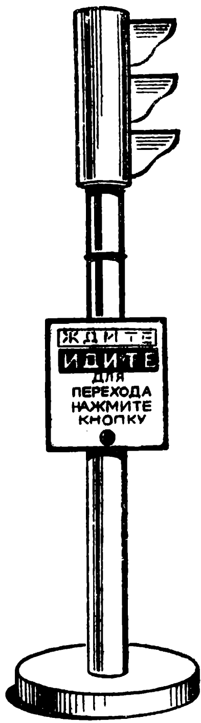
Рис. 14. Модель светофора с вызывающим устройством для пешеходов.
