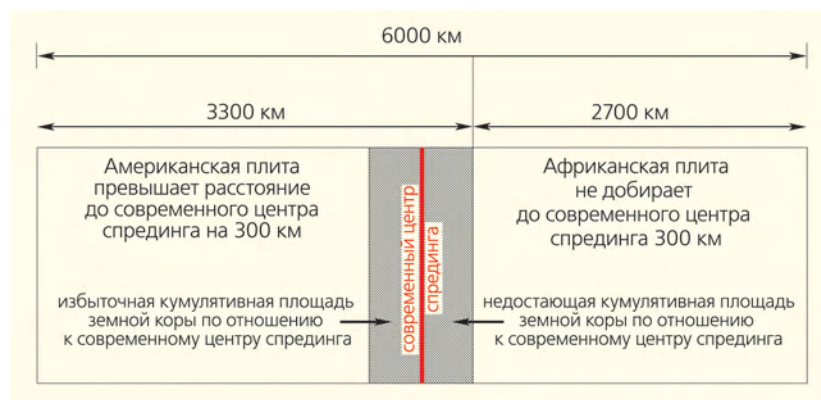
Рис.9. Принципиальная схема асимметричного спрединга в Южной Атлантике. Компенсация и декомпенсация коры происходит изначально путем джампинга со стороны Африканской плиты с отчленением фрагментов Американской. Загадка, пока не разрешимая, заключается в режиме джампинга, скорее всего, нелинейного. Продолжительность спрединга — 140 млн лет, скорость движения Американской плиты — 2.3 см/год, Африканской — 1.9 см/год.
