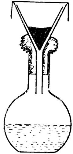
Фиг. 1. Способ фильтрования почвенной болтушки через стерильный бумажный фильтр. В колбе — почвенная вытяжка.
