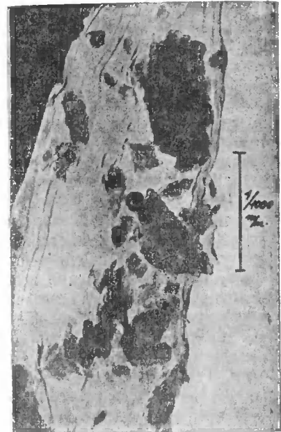
Фиг. 3. Синтетический каолин H_2Al_2Si_2O_8 \cdot H_2O (по W. Noll). Сфотографировано с электронным микроскопом при увеличении в 23 000 раз. Пример использования нового метода идентификации минерала. (Фото взято из статьи W. Eitel [6].)
