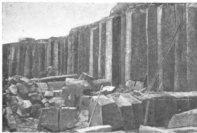
Фиг. 4. Разработка столбов базальта на одном из карьеров «Яновой долины». На переднем плане — расколотый столб с характерными ровными изломами по плоскостям, перпендикулярным к его оси.
