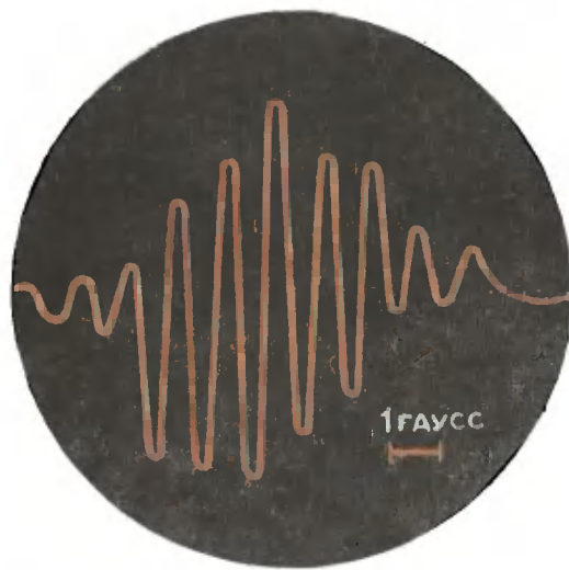
Рис. 12. Спектр ЭПР (производная от поглощения) радикала кофермента Q, важного участника процессов переноса электронов в клетках животных. Спектр получен из препарата митохондрий печени крысы. Четкая сверхтонкая структура из 9 линий обязана взаимодействию электрона с протонами метильной и метиленовой групп этого радикала.
