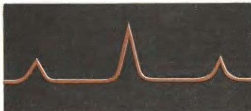
Рис. 8. Спектр ЭПР на частоте 10^{10} герц ионов трехвалентного хрома, введенного в искусственный монокристалл рубина. По горизонтальной оси отложена величина напряженности магнитного поля, а по вертикальной оси — величина поглощения. Появление вместо одной трех линий поглощения связано с влиянием кристаллического поля на ион хрома.
