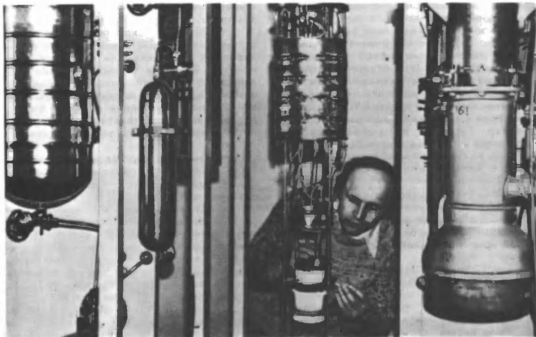
Общий вид капориметра для исследований криокристаллов при температурах до 0,4 К.
