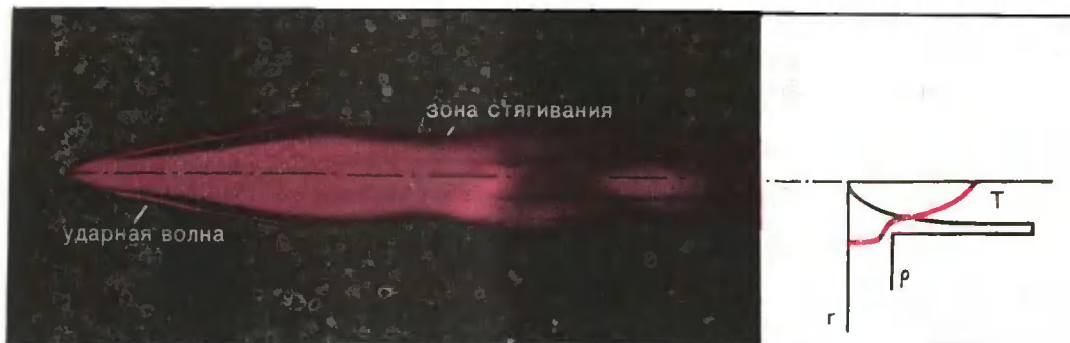
Рис. 7. Фотохронограмма и структура отдельного канала разряда в газе. Справа — профиль температуры T в разряде и скачок плотности \rho вблизи фронта ударной волны.
