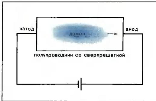
Схема генератора Ганна. Цветом выделен домен — область повышенной напряженности поля, стрелкой указано направление его движения.
