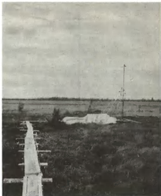
Место полевых измерений на Бакчарском болоте. Досчатые мостки предохраняют болото от выталтывания и искусственного выдавливания болотных газов. На заднем плане — микрометеорологическая установка.
