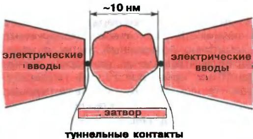
Геометрия экспериментов, в которых обычно изучаются мезоскопические свойства металлических наночастиц.
