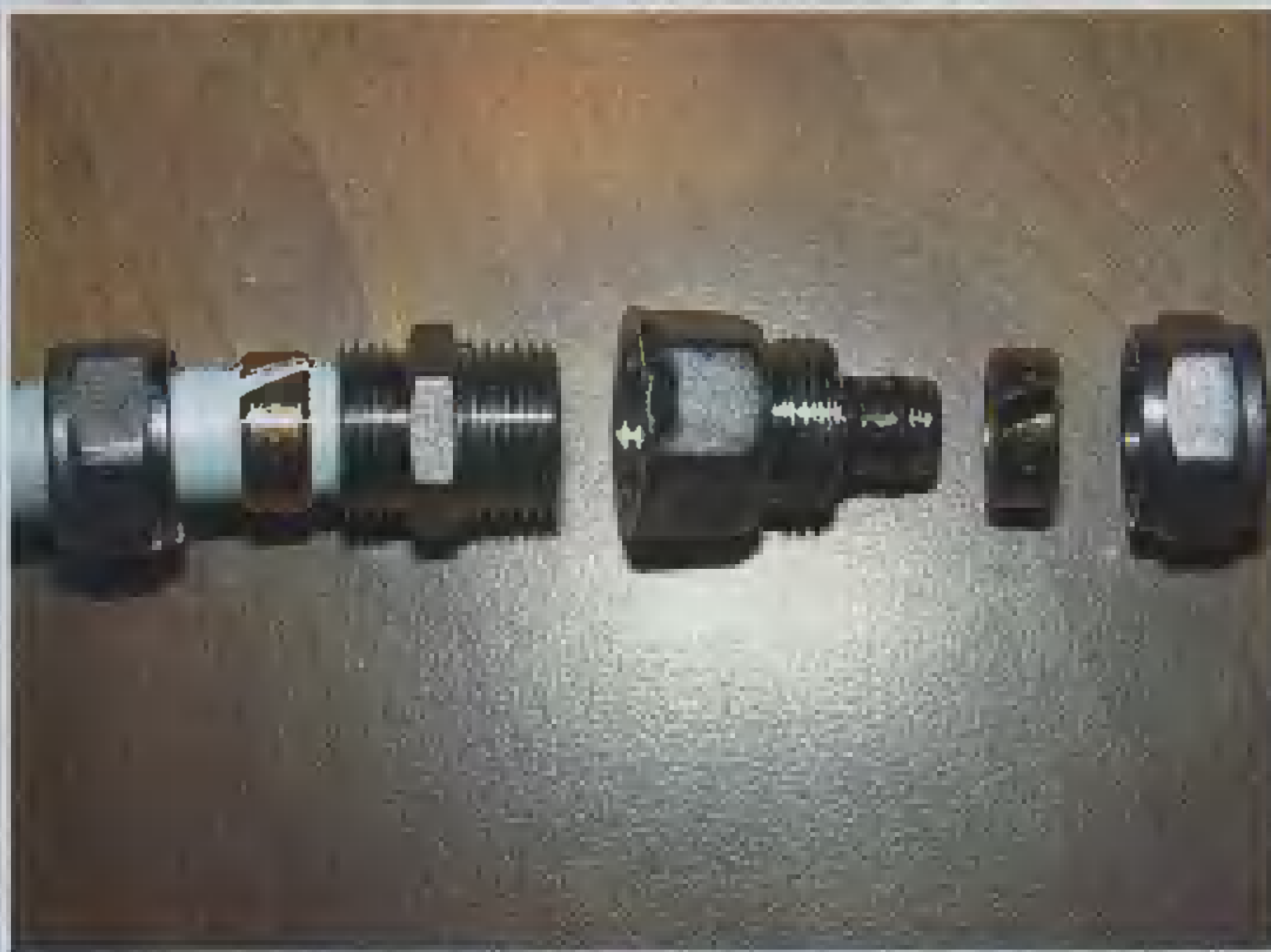
Для соединения труб из металлопластика достаточно двух гаечных ключей и ножовки по металлу
