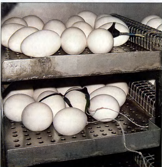
Датчики температуры закреплены на самих яйцах
