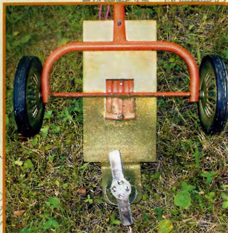
«Брюхо» газонокосилки - шасси и крыльчатка с двумя ножами
