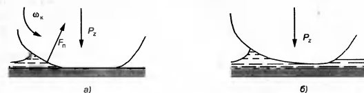
Рис. 2.9. Взаимодействие колеса и мокрой дороги: а — при частичном контакте шины с поверхностью дороги; б — при полном отсутствии контакта
