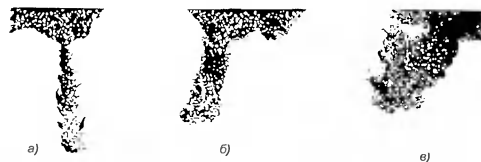
Рис. 3.16. Развитие топливных струй в заряде: а — неподвижном; б — движущимся со скоростью 15 м/с; в — движущимся со скоростью 35 м/с
