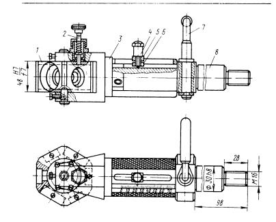
Рис. 610. Приспособление для нарезания резьбы плашками
