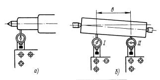
Рис. 7.9. Контроль смещения задней бабки
