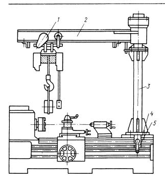
Рис. 8.3. Подъемно-транспортное устройство на станке: 1 — электрическая таль, 2 — поворотная стрела, 3 — колонна, 4 — плита, 5 — механизм перемещения колонны
