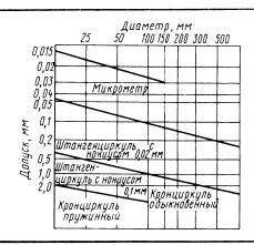
Рис. 7.1. Диаграмма для выбора измерительного инструмента в зависимости от диаметра измеряемой поверхности и точности обработки
