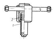
Рис. 6.4. Травмобезопасный ключ для закрепления детали в кулачковом патроне
