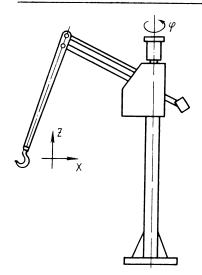
Puc. 8.4. Схема манипулятора с ручным управлением
