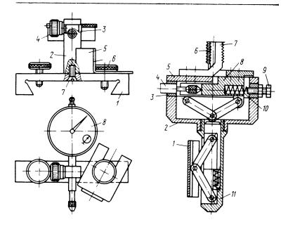
Рис. 7.7. Устройство для измерения в процессе обработки наружных и внутренних диаметров с точностью до 0,01 мм
