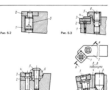
Рис. 5.2. Резец с эксцентриковым механизмом зажима: 1 — корпус, 2 — режущая пластина, 3 — эксцентрик
