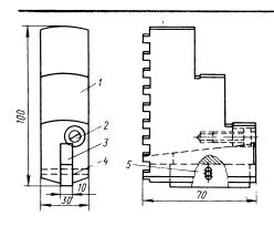
Рис. 6.3. Регулируемый кулачок, устанавливаемый в стандартный патрон
