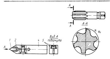
Рис. 5.9. Резьбовой резец:
