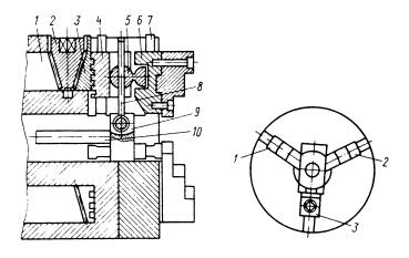
Рис. 6.1. Приводной самоцентрирующий патрон
