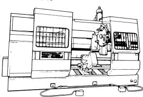
Рис. 4.1. Токарный патронно-центровой полуавтомат с ЧПУ мод. 1740РФ3
