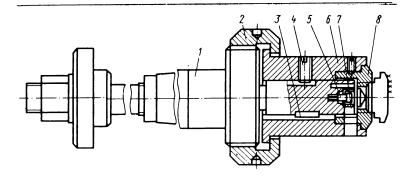
Рис. 6.8. Универсальная резьбовая оправка
