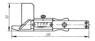
Рис. 7.4. Приспособление для контроля фасок
