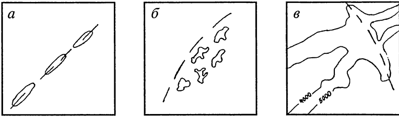
Рис. 8.1. Выделение разломов по рельефу дна океана (в плане): а – по локальным депрессиям; б – по коралловым островам; в – по конфигурации изобат
