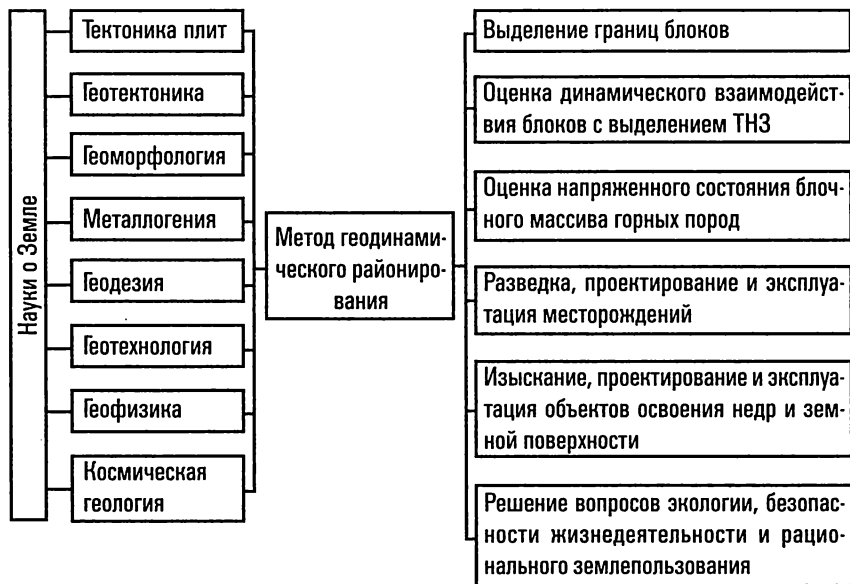
Рис. 7.2. Логико-структурная схема геодинамического районирования месторождений
