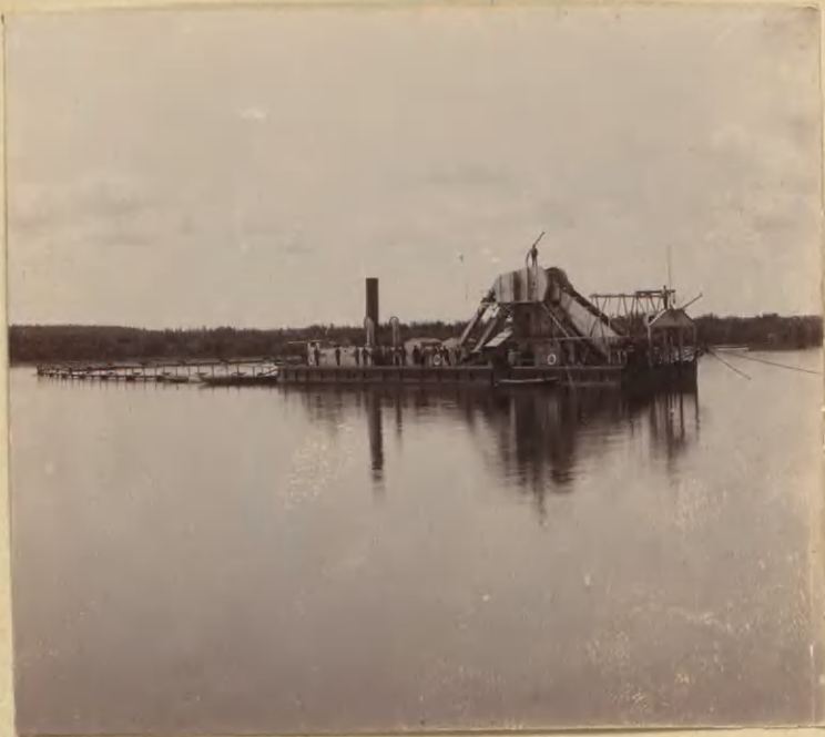
Землеротательная машина "Шекснин- ская I ая " с черпаками и рефурером.
