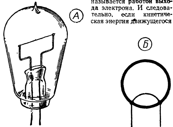
Рис. 1. Катод прямого накала делается в виде тонкой нити на двух ножках (остальные электроды лампы на рис. А не показаны). В схемах катод прямого накала обозначается так, как указано на рис. Б
