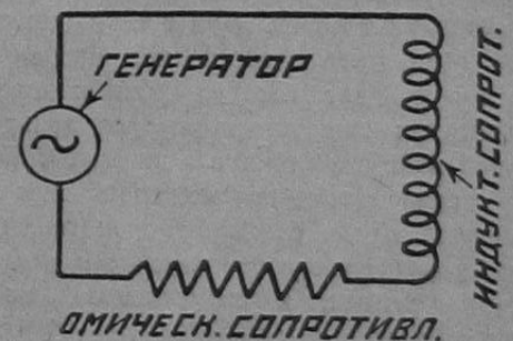
Рис. 4. Действие самоиндукции в цепи переменного тока.
