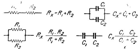
Если один из конденсаторов под рукой любителя будет не в 1 000 см, а в 1 500, то, как показывает таблица, соединение 1 500 и 500 см последовательно даст 375 см. Вряд ли эта замена будет работать хуже, чем нужный конденсатор в 300 см.
