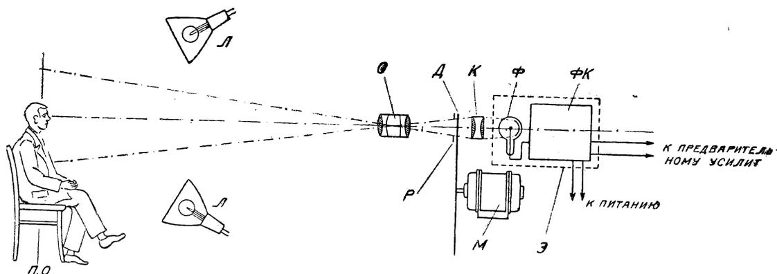
Рис. 1. Схема передатчика прямого видения
