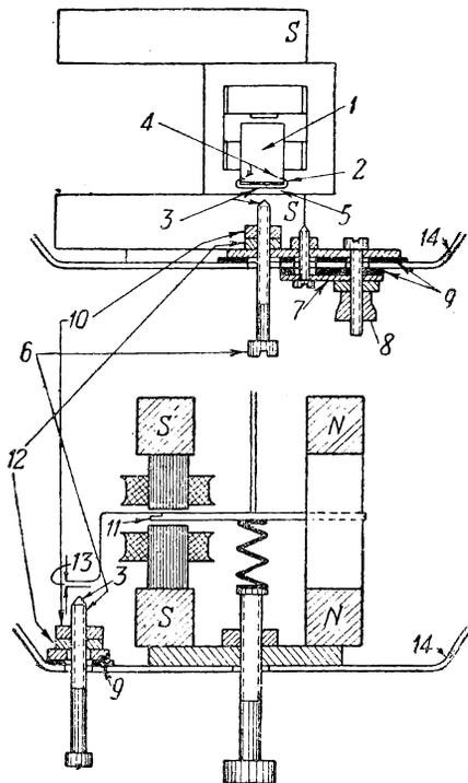
батарейку. Чтобы контактный винт не отвертывался во время работы, надо его закрепить контргайкой 10. Если контактный винт будет задевать за стойку репродуктора, ее надо немного спилить. После регулировки надеваем диффузор, что усилит звук в несколько раз. При использовании репродуктора для приема следует контактный винт повернуть на 2—3 оборота и приключить репродуктор обычным способом к клеммам приемника.
