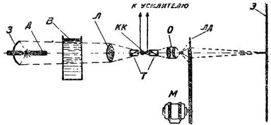
Рис. 8. Схема оптики приемного устройства
