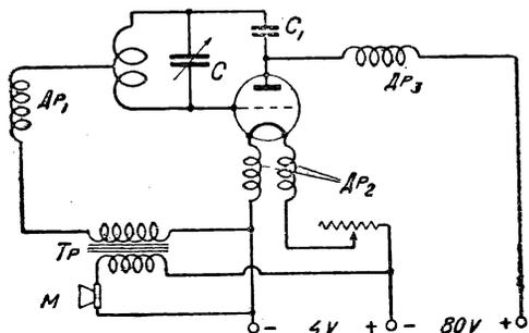
Рис. 3. Схема с сеточной модуляцией
