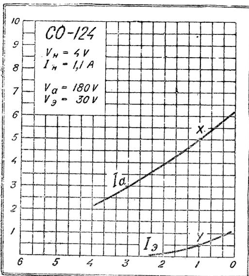
лампах. На управляющую сетку первой лампы подается отрицательное смещение за счет падения напряжения в сопротивлении  $R_3$ , через которое протекает анодный ток этой лампы. Очевидно, что для того чтобы определить величину сопротивления  $R_3$ , нужно предварительно знать две цифры — величину того смещения, которое будет задаваться на сетку лампы, и величину анодного тока лампы, который будет протекать через сопротивление.
