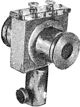
Рис. 6. Конденсатор Керра (в собранном виде)
