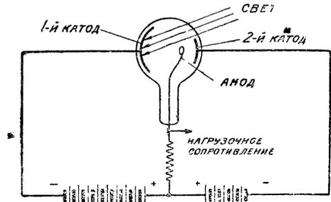
Рис. 4. Схема включения фотоэлемента со вторичной эмиссией
