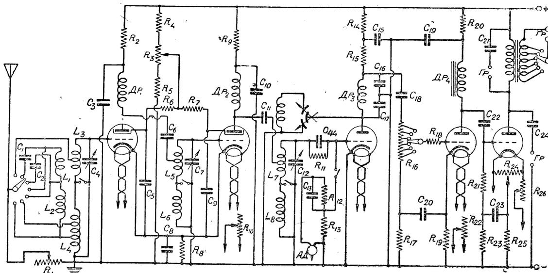
Рис. 4. Схема приемника тов. Срединского
