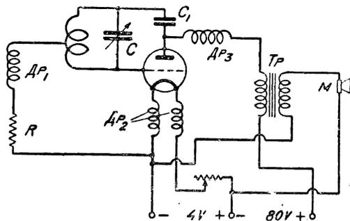
Рис. 2. Принципиальная схема передатчика
