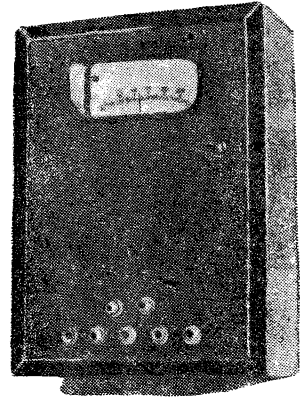
Рис. 4. Высокоомный вольтметр из гальванометра — 100 000 омов на вольт
