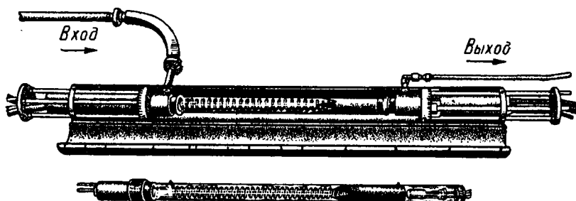
Рис. 4. Усилитель и лампа с бегущей волной на волну около 60 см и мощность около 1 квт
