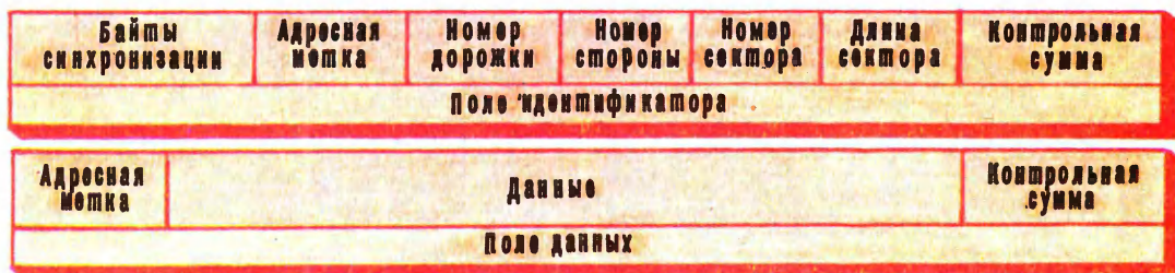
Рис. 3. Структура сектора дорожки гибкого диска
