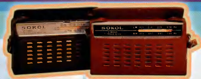
Одни из первых радиоприемников завода 1969 — 1972 гг. Двухдиапазонные приемники на семи транзисторах.
