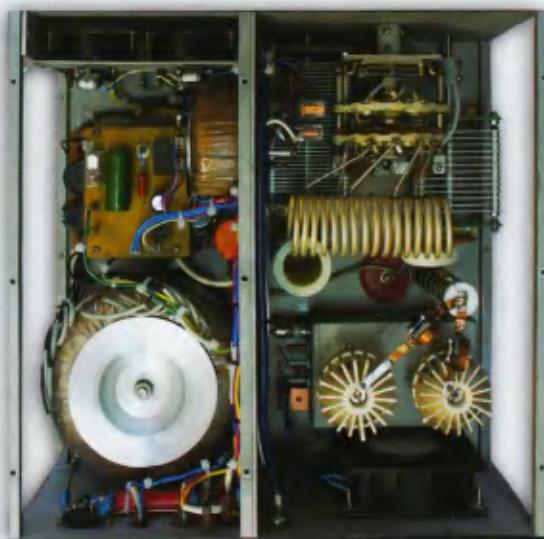
КВ усилитель мощности — вид на монтаж сверху.
