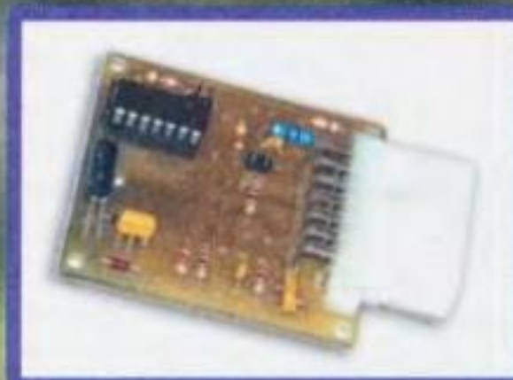
"Блок зажигания — регулятор угла 03 на микроконтроллере PIC16F676"
